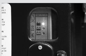
8. Vérifier le niveau de charge de la batterie et, si nécessaire, la recharger
